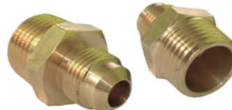
Adaptador Macho-Tuerca-Macho-Cono 1/2" NPT x 3/8" UNF (Cono Salida se une a 114021901 y 114042901) 113832691
